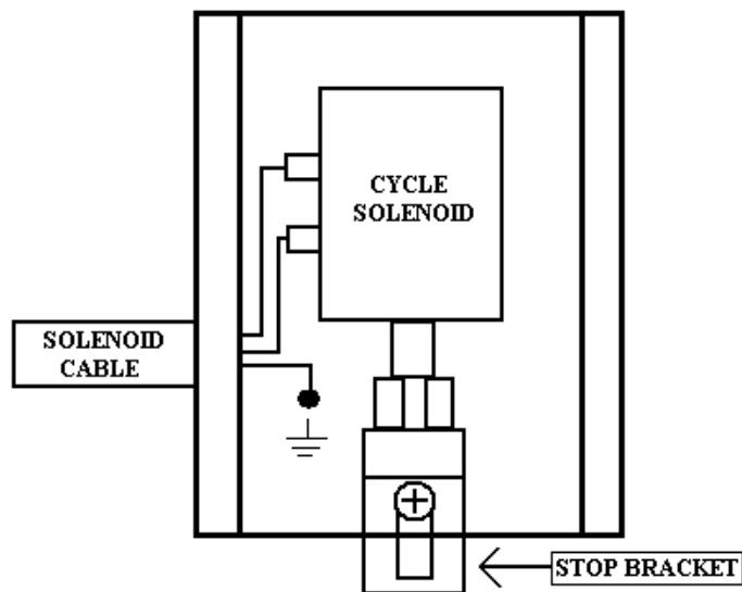
STOP BRACKET REDUCES THE PLUNGER TRAVEL PREVENTING IT FROM PULLING SO HARD ON THE CLUTCH TRIP LEVER
