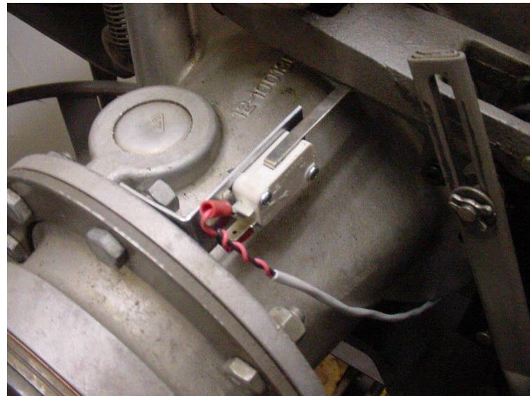
ILLUSTRATION SHOWS LEVER IS DEPRESSED AT 0 DEGREES AT IDLE
