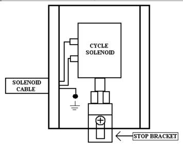
STOP BRACKET REDUCES THE PLUNGER TRAVEL PREVENTING IT FROM PULLING SO HARD ON THE CLUTCH TRIP LEVER
